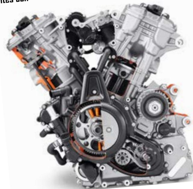
10-Las cuatro levas tienen sincronización variable de válvulas, y cada cilindro obtiene diferentes configuraciones para una banda de potencia más amplia. La variabilidad funciona en un rango de 40 grados de rotación del cigüeñal. El cambio en la sincronización de la leva se realiza mediante un émbolo de solenoide que opera en un sistema hidráulico portado.
